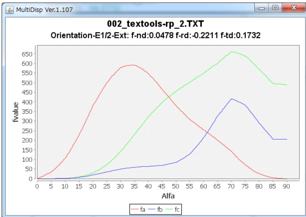
C軸が TD 方向が多く、ND 方向は r a n d o m、RD 方向には、少ないが垂直状態
